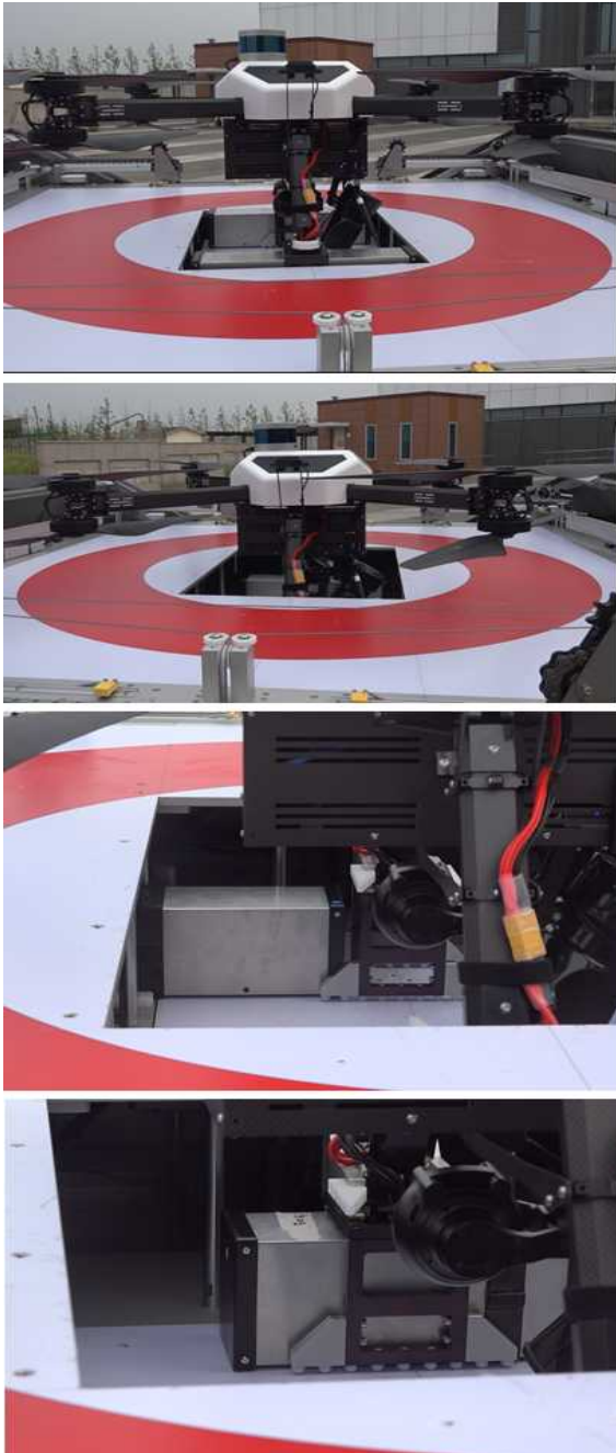
그림 6. 드론스테이션의 배터리 교체 장치 사진 Fig. 6. Pictures of battery replacement machine in the drone-station
