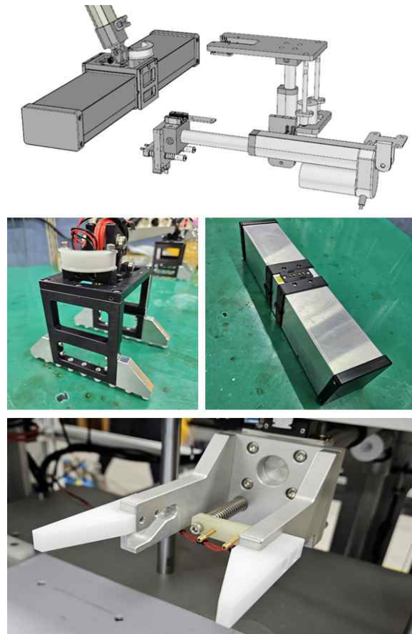
그림 8. 교체형 배터리 기계적 장치 Fig. 8. Mechanism of the replaceable battery
