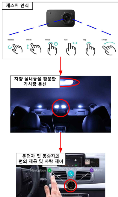
그림 1. 차량 실내등을 활용한 가시광 통신 기반의 차량 제어를 위한 제스처 인식 정보 전송 Fig. 1. Gesture Recognition Information Transmission for Visible Light Communication-based Vehicle Control Using Vehicle Interior Lights
