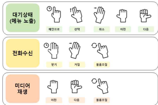
그림 3. 제스처 인식을 통한 제어 시나리오 Fig. 3. Control scenario based on gesture recognition
