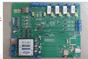
Fig.6 제어용 인버터 보드 제작 결과
