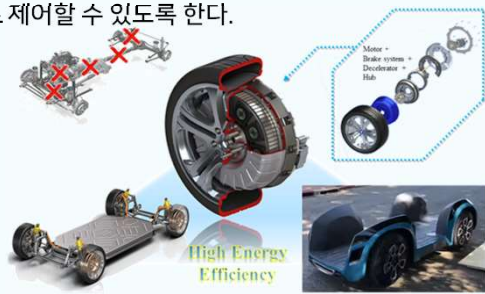
Fig.1 인휠모터 등장에 따른 구조 변화
