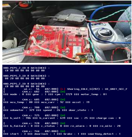
그림 3. 차량 OBD 연결 및 통신 테스트 진행 Fig. 3. OBD Connection and Communication Test
